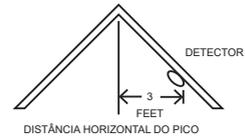
Figura 5: LOCAIS RECOMENDADOS PARA MONTAGEM DE DETECTORES DE FUMAÇA EM QUARTOS COM TETO INCLINADO
